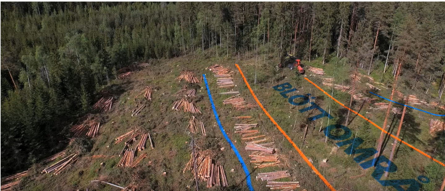
Spøkslag markert med oransje der hogstmaskina kjører kun en gang, og der lassbæreren kjører kun på de blå veiene (Skjermdump fra filmen Sporløs kjøring)
