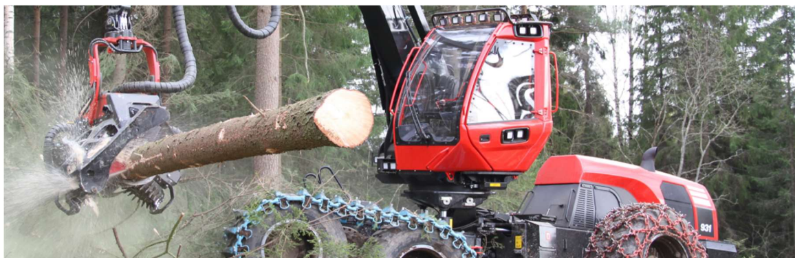
Bilde 7: Avvirkning med Komatsu 931.
