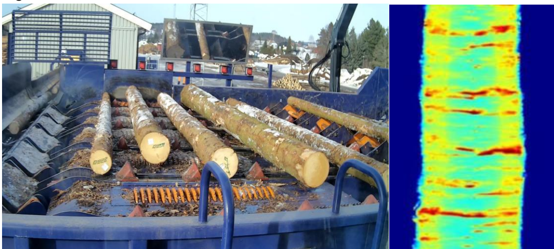
Figur 15. Stokker merket med RFID på vei inn i saglinja (venstre) og røntgen bilde av en stokk med kvistbilde og skader (høyre).
