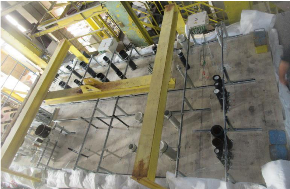
Test av massivt tre element (3m x 6m) med tekniske gjennomføringer branntettet med Protecta produkter.
