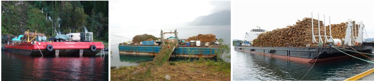
Figur 5. Lekter som plattform for taubanedrift (venstre) og som Ro-Lo mobilkai (høyre). Norge.
