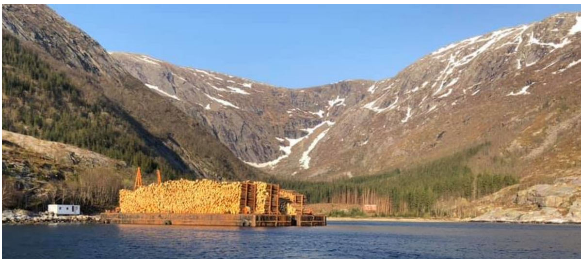
Figur 3g. Fullastet leker (3000-3500 m 3 , ca. 6 m lasthøyde).
