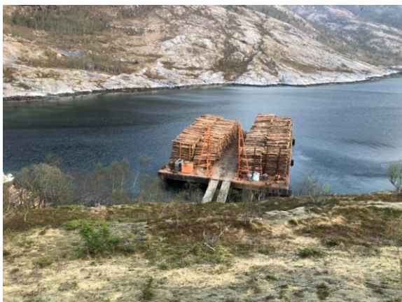
Figur 3a. 24 x 55 m lekter med 10 m lasterampe.
