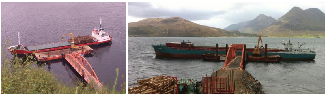
Figur 4. Leker med linksplan for direktelasting til fartøy. Skottland (FBP 2010).
