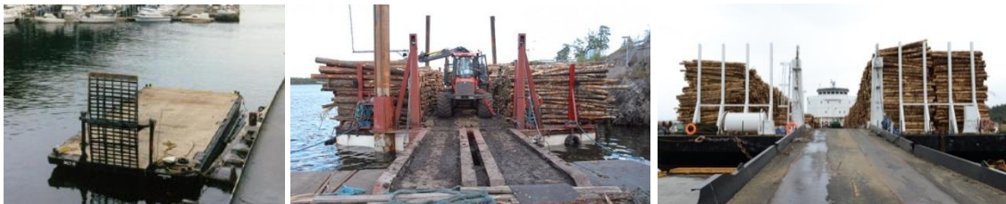
Figur 3. Ulike rampeløsninger for Ro-Lo drift.
