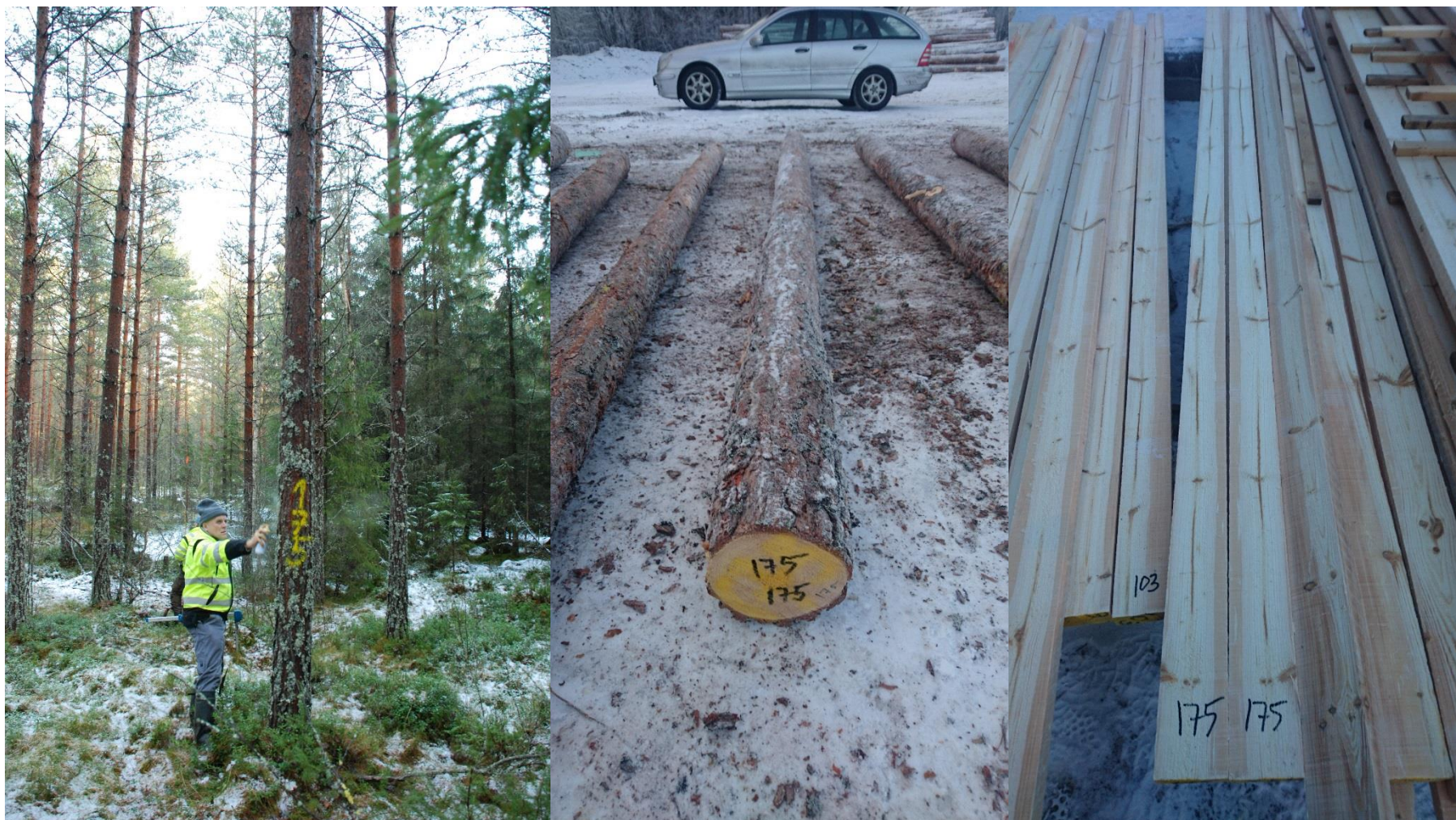
Bilde 3: Tre nummer 175 som henholdsvis prøvetre, stokk og planker. Tre nummer 175 har blitt klassifisert som sagtømmer, sams og 6. sort. Av synlige feil har man avdekket føyre etter oppdeling.
