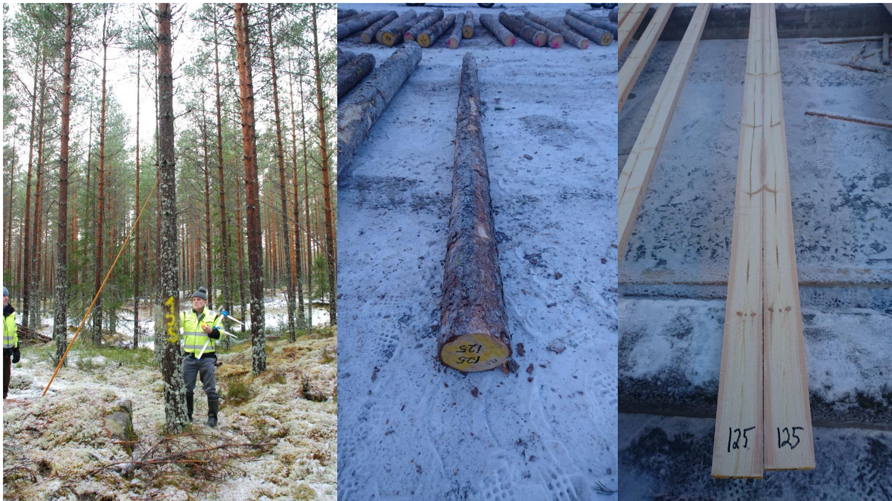
Bilde 1: Tre nummer 125 som henholdsvis prøvetre, stokk og planker. Tre nummer 125 har blitt klassifisert som sagtømmer, sams og kledning, og ingen beiteskader eller synlige feil er registrert.
