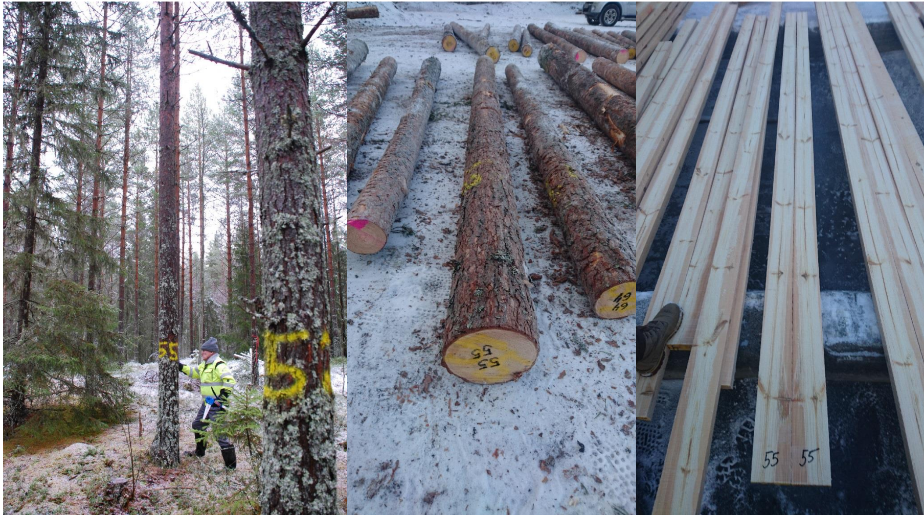
Bilde 2: Tre nummer 55 som henholdsvis prøvetre, stokk og planker. Tre nummer 55 har blitt klassifisert som sagtømmer, sams og K-virke. Av synlige feil er det registrert overrookst føyre (tømmermåler), og toppbrudd (etter oppdeling). Det er tillatt med små toppbrudd i konstruksjonsvirke.
