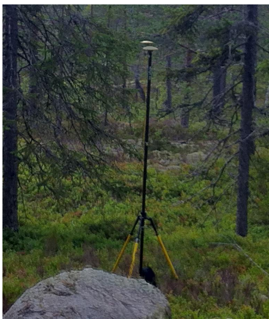
Topcon GNSS mottaker for logging av "korreksjonsdata"
