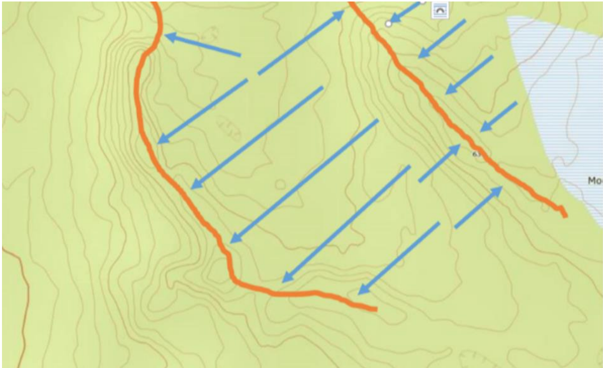
Figur 26. Her er basvegene (røde) lagt oppe på de høyere delene i terrenget, i dette tilfelle, to eskere, se også fig. 27. Driftsvegene (blå), viser at virket hentes opp av en fuktigere forsenking for å unngå terrengskader.
