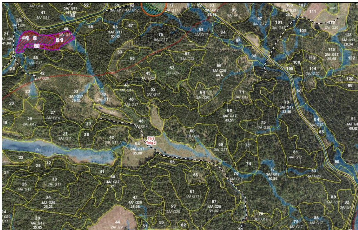
Figur 28A. Kartutsnitt fra Allma 2. Ortofotokart der de blå feltene viser hvor det er sannsynlig å finne vann som påvirker bæreevnen.
