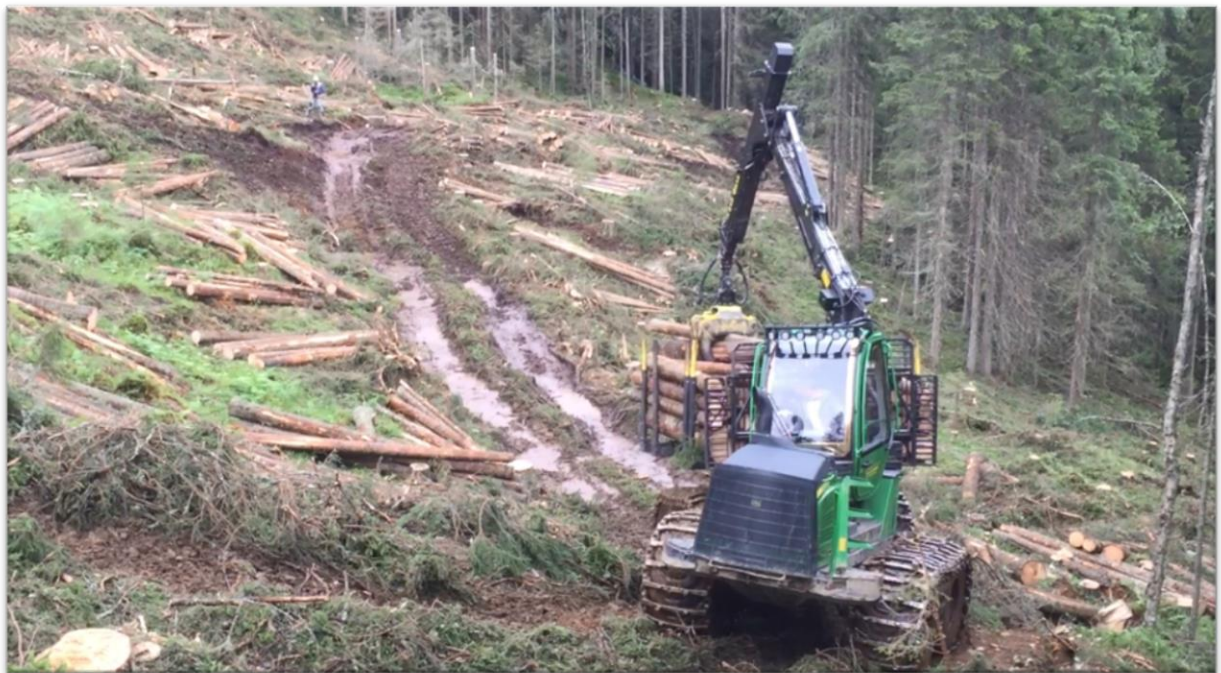
Figur 14. Vegetasjonstypen høgstaudekog forekommer ofte som mindre partier i terrenget, som her langs en kilde i hellende terreng. De er vanskelige å unngå. Her er det viktig å sørge for at vannet ledes bort kontinuerlig, det vil gi mindre terrengskader.
