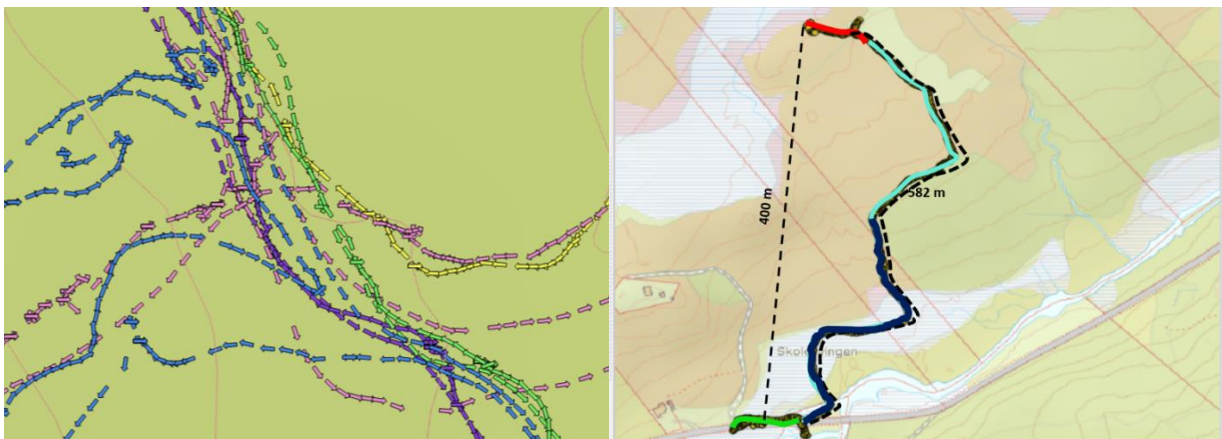
Figur 10. Bruk av lassbærers GPS-sporlogger data for å beregne kjørehastigheter (venstre) og driftsveiens geometri (høyre).
