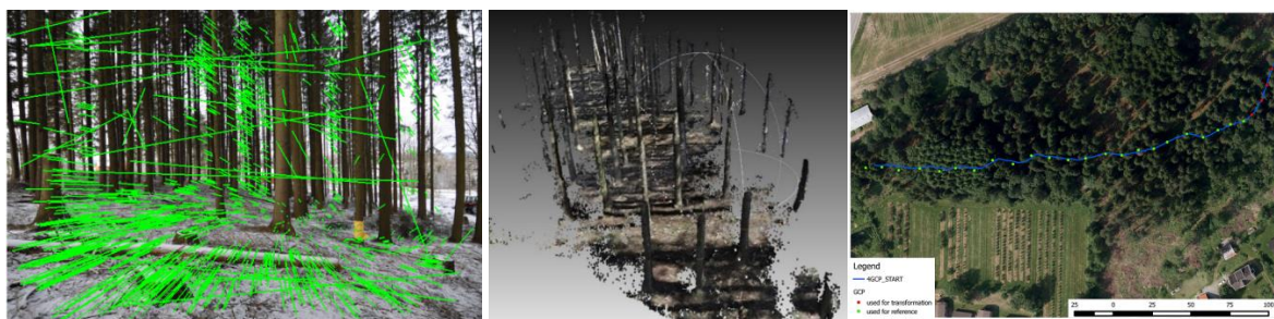
Figur 18. Navigasjon uten GPS ved bruk av Structure-from-Motion (SfM). De grønne streker visere forandring i posisjoner (venstre) som danner grunnlag for 3-D rekonstruksjon (midten). Den stiplede linje angir posisjon på kameraet (høyre).
